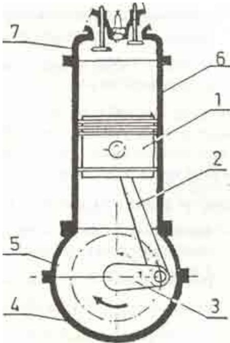
Glavni delovi klipnog rnotora SUS.
